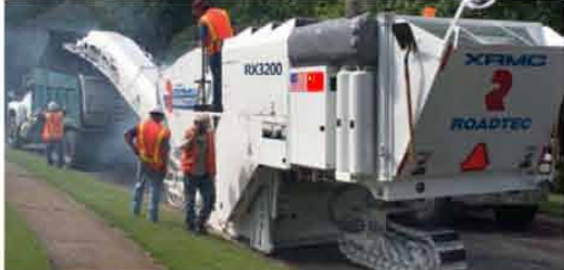
RX-4000型铣刨机 RX-4000 cold planer 950 hp/ 708 kw
