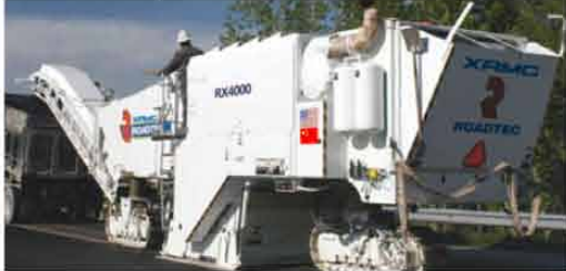
RX-4000型铣刨机 RX-4000 cold planer 950 hp/ 708 kw
