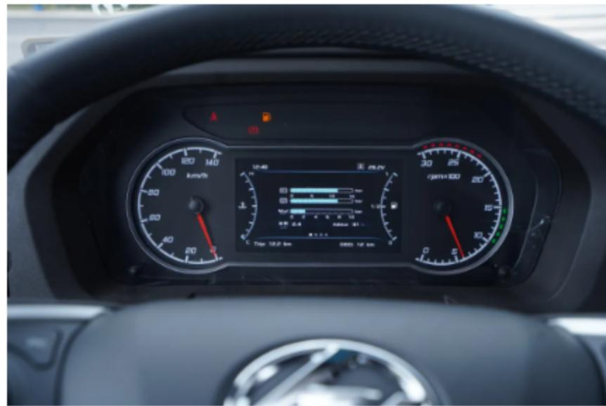
在换挡操纵方面，标配换挡助力，开启更轻松的操控模式，有效减少卡友劳动强度。此外，采用了推拉式换挡机构，安置在中控台底部的延伸位置，可以提供更多宽敞的地板空间，方便卡友在特定时间驻车休息。
