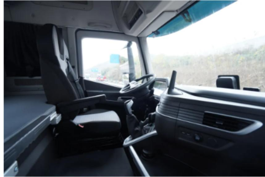
搭载全新升级通风加热座椅，阻尼可调，肩部可调以及双级腰部支撑，功能更全面，有效提升行车舒适性，降低驾驶疲劳。
