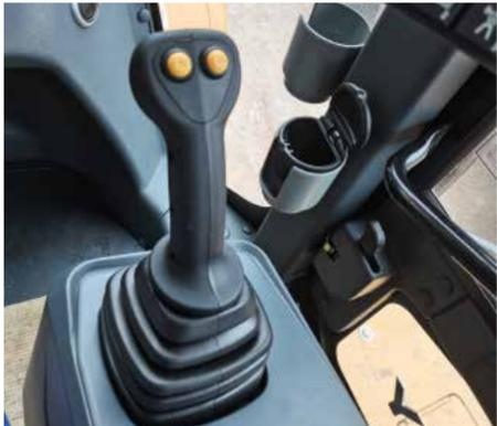
操纵手柄有“先导式单手柄”和“机械式双操纵杆”可选择，以适应不同操作手的使用习惯。
