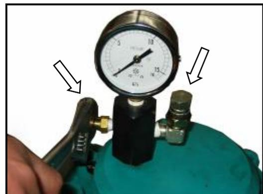
5. 用内六角扳手逆时针方向旋转蓄能器侧面的阀芯,缓慢打开充气阀,此时压力计指针开始移动。记录下蓄能器内的氮气压值。(标准值可参照表2)
