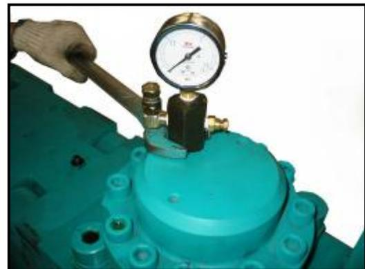
4. 确认蓄能器测压表具上的充气盖和放气阀处于拧紧和关闭状态（注意：阀芯顺时针旋紧时为充气阀关闭状态）。
