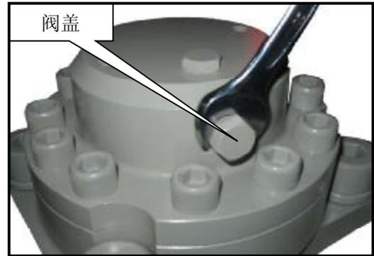
2. 用扳手卸下蓄能器盖顶部的螺堵（连同同一个O型圈）。
